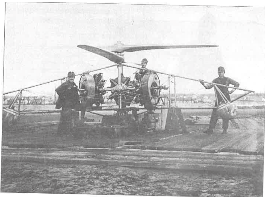
Obsluha připravuje vrtulník ke startu. Stroj je umístěn na přistávacím vaku. Jsou patrné tři hvězdicové motory, před nimi jsou upevněny plechové palivové nádrže vejčitého tvaru.
