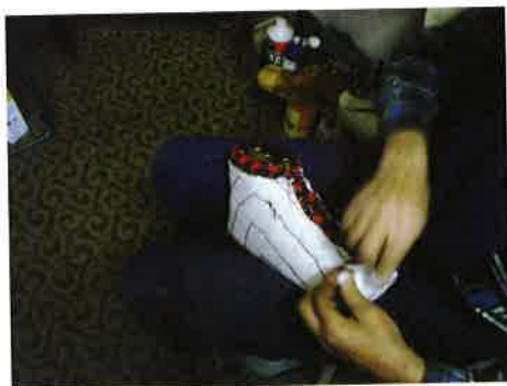
do flanelového základu bandury se vloží dřevěné kopyto a na něm se zbylý volný flanel sešije k sobě
