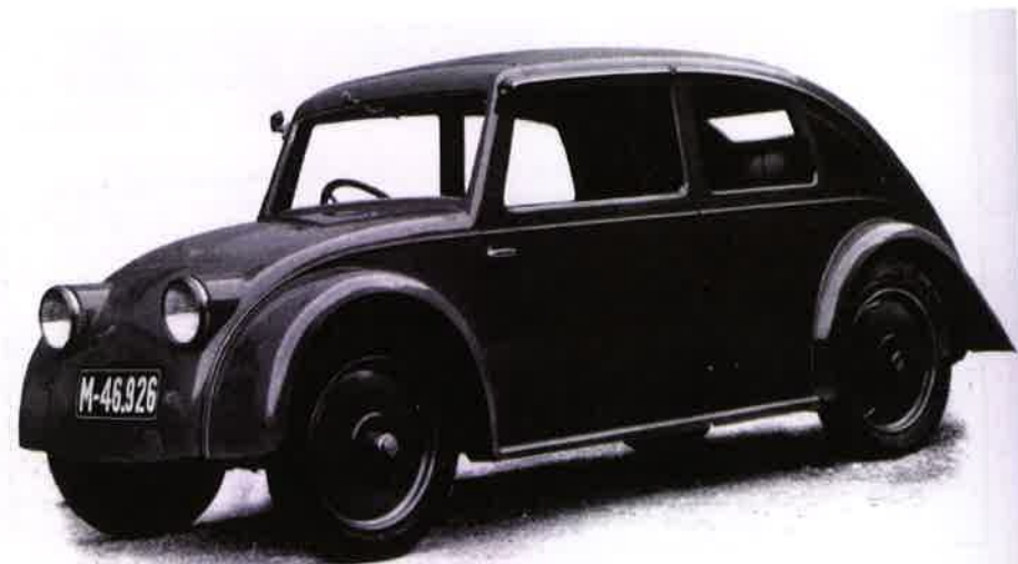
Prototyp lidového vozu Tatra V570, poprvé se vzduchem chlazeným motorem uloženým vzadu
